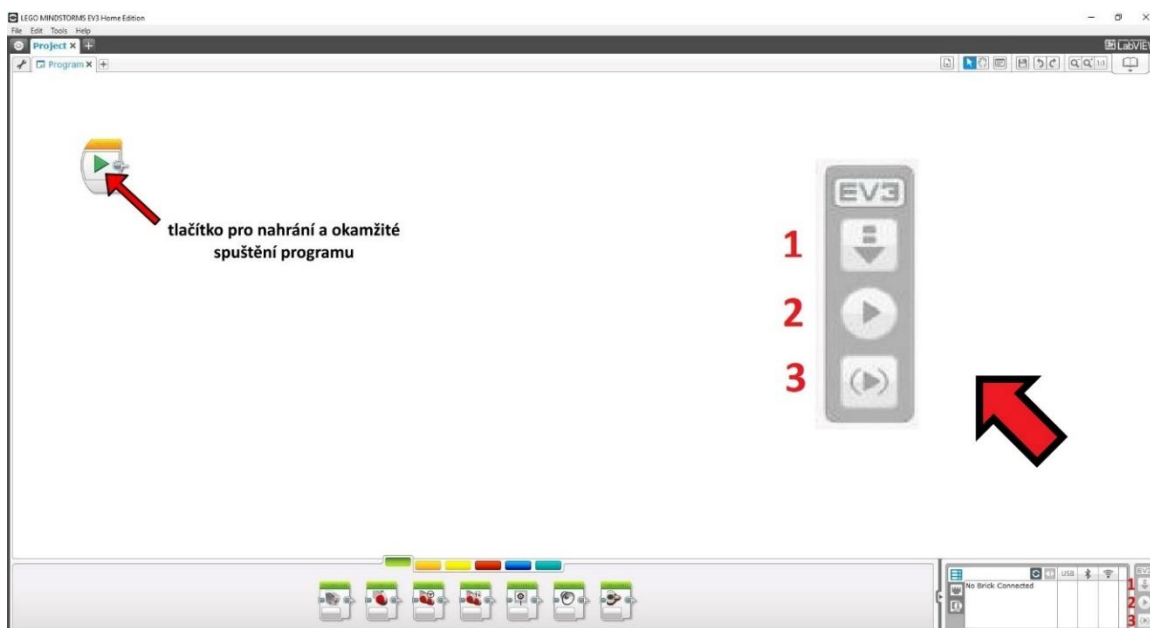
Obrázek 2 – Možnosti nahrání programu do řídicí jednotky a jeho spuštění v EV3.
